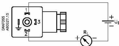
Электрическое подключение преобразователя с штекером DIN 43650 для выходного сигнала 4 – 20 мА
