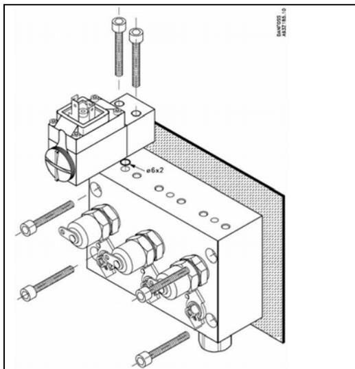
Блок тестирования клапанов MBV 5000 блочной конструкции предназначены для быстрой установки преобразователей блочной конструкции, а также проверки импульсных линий давления в системах контроля в промышленности и морском секторе. На один тестовый клапан может быть установлено до 5 преобразователей или реле давления.
