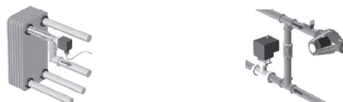
Убедитесь в чистоте и гладкости поверхности трубы в месте установки датчика.
