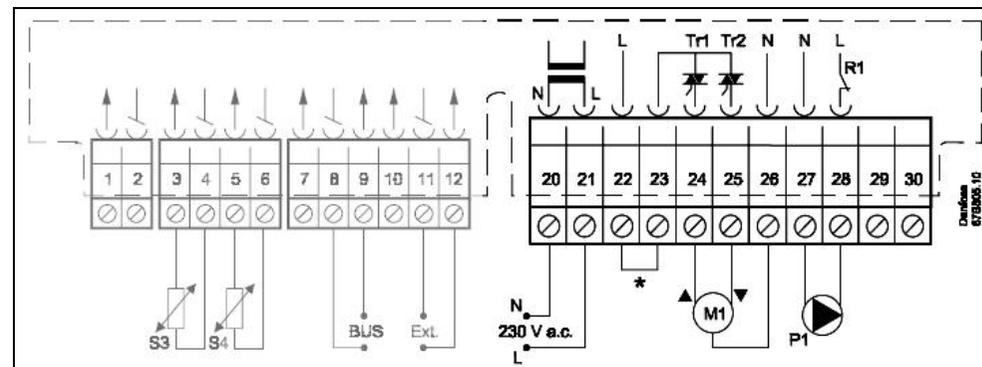
\* Резервные клеммы для предохранительного термостата
