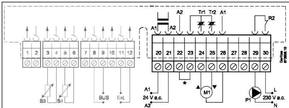
\* Резервные клеммы для предохранительного термостата
