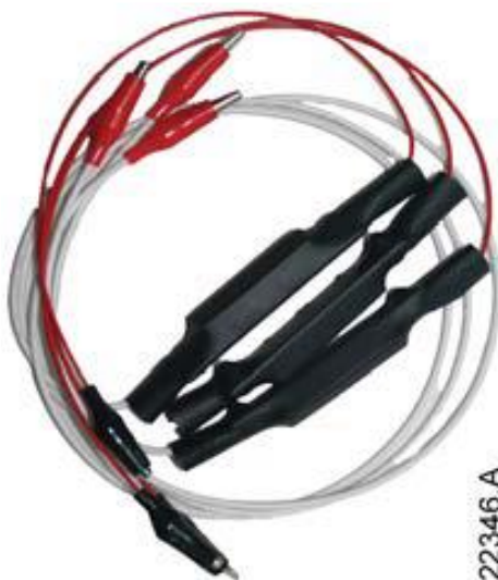
Рис. 3.4 – Комплект резисторов для проверки с двигателем низкого напряжения
