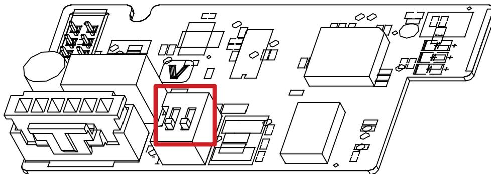
Рис. 4. Переключатель терминатора
