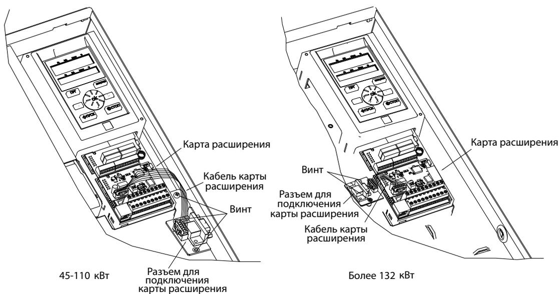
Рис. 2.2. Монтаж платы на преобразователях частоты высокой мощности
