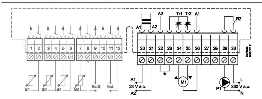
\* Резервные клеммы для предохранительного термостата
