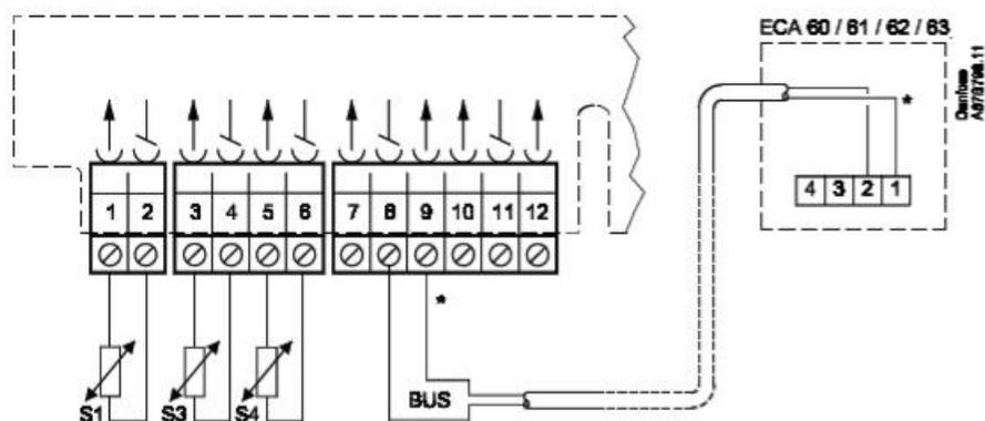
\* Подсоедините клемму 9 ECL к клемме 1, а клемму 8 к 2
