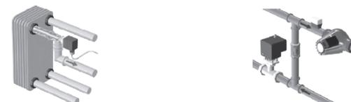
Убедитесь в чистоте и гладкости поверхности трубы в месте установки датчика.
