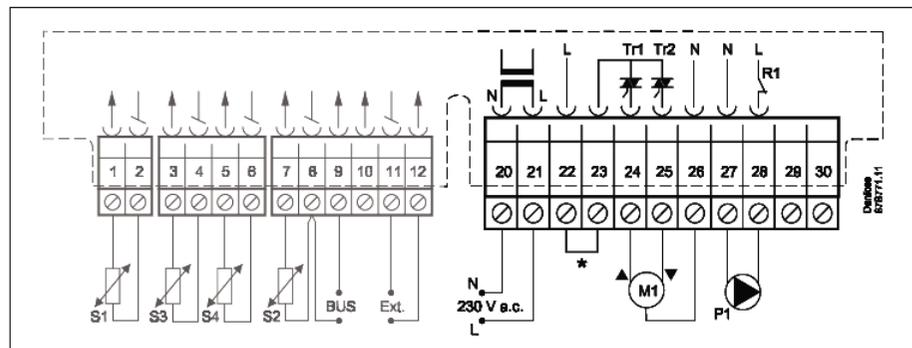
\* Резервные клеммы для предохранительного термостата
