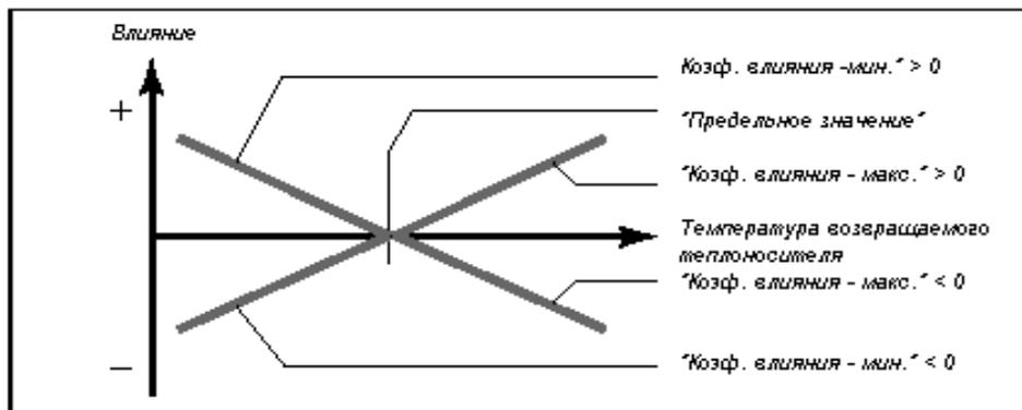
Это ограничение основывается на PI- регулировании, при котором P (коэффициент влияния) быстро реагирует на отклонения, а I (время интегрирования) реагирует медленнее и со временем устраняет небольшую разницу между заданными и фактическими величинами. Это достигается путем изменения заданной температуры подаваемого теплоносителя.
