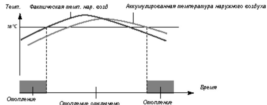
Данная функция экономит энергию, отключая систему отопления, когда температура наружного воздуха превышает установленное предельное значение. Система отопления снова включается, когда температура наружного воздуха и аккумулятивная температура наружного воздуха опускаются ниже установленного предельного значения.
